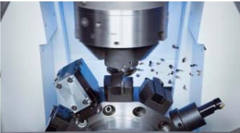
*Mit der Vertikaldrehmaschine revolutionierte EMAG die Serienfertigung im Automobilbereich. Die Vertikaldrehmaschine wird zum Drehen, Fräsen, Bohren und zur Bearbeitung von runden Werkstücken eingesetzt*
