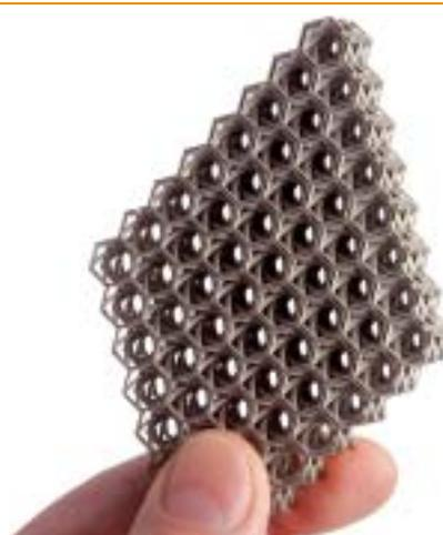
*Das Renishaw Laserschmelzverfahren ist ein zukunftsweisendes Schichtaufbauverfahren, um sehr dichte Metallteile direkt aus dem 3D-CAD-Datensatz herzustellen*
