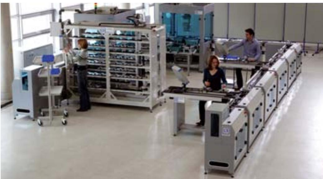
*Roboter und Menschen arbeiten künftig immer häufiger Hand in Hand: Wie Montagelinien mit kombinierten Roboter- und Handarbeitsplätzen aussehen können, zeigt die Lernfabrik des IFF (Bild: IFF)*
