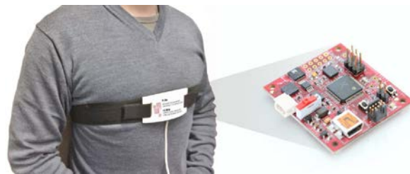
Inertialsensorik zur Sturzdetektion und Bewegungserfassung von Personen
