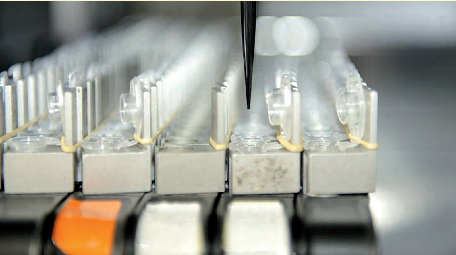
Pipettierroboter für automatisierte Probenbearbeitung bei der GATC Biotech AG.
