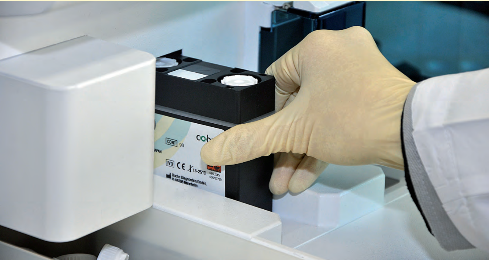
Typische Reagenzkartusche heutiger In-vitro-Diagnostik-Laborsysteme.
