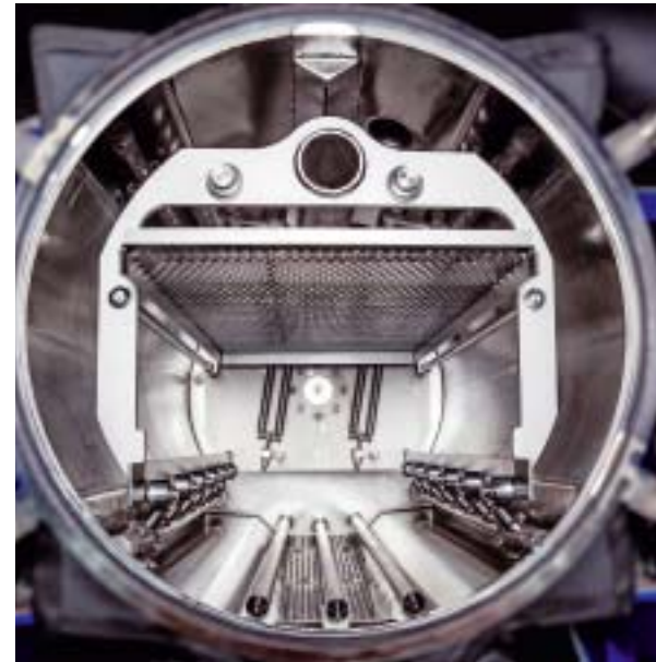
Das Herzstück einer Anlage: Arbeitskammer mit rotierender Korbaufnahme, Ultraschall und Turbulenzdüsen. Durch die serienmäßige Glastüre lässt sich der Reinigungs- und Trocknungsprozess optimal beobachten
