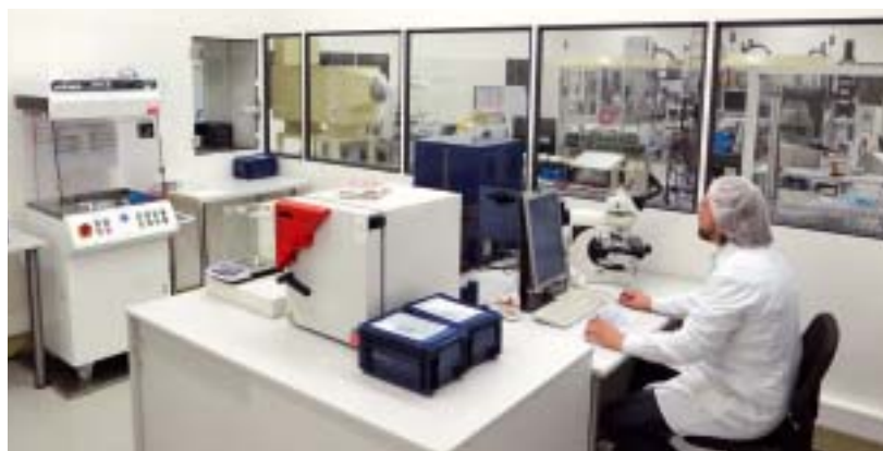
Komplett eingerichtetes Sauberräumlabor zur Prüfung der Bauteilsau- berkeit nach VDA19
