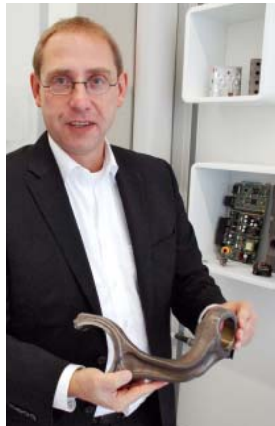
Am Beispiel einer zerstörten Lkw-Pleuelstange demonstriert Dr. Markus Rochowicz, Gruppenleiter Reinigungstechnik am Fraunhofer IPA, die möglichen Folgeschäden partikulärer Verunreinigungen im Automobilbau
