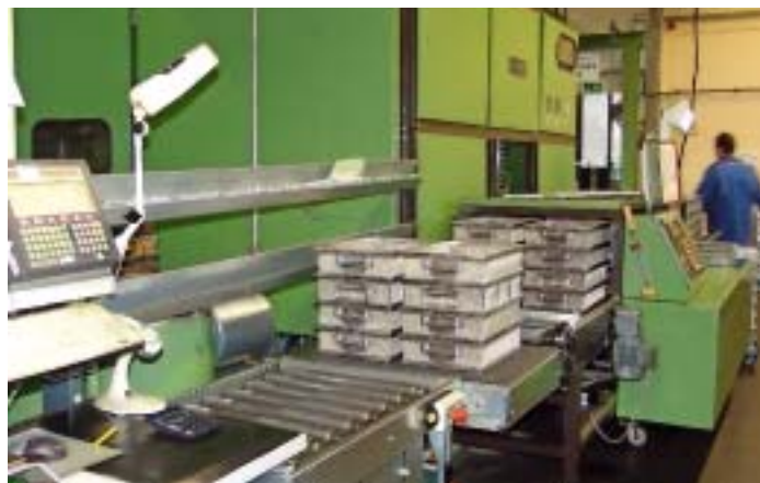
Lösemittel-Reinigungsanlagen, die üblicherweise für die Entfernung unpolarer Verunreinigungen eingesetzt werden, verfügen über eine integrierte Destillationseinrichtung zur Aufbereitung der Lösemittel (Bild: Pero)
